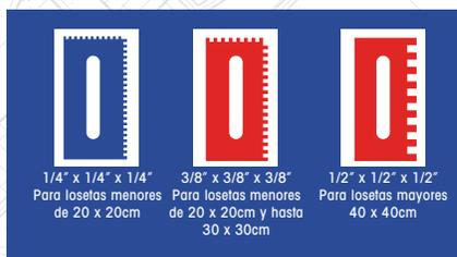
Con el uso de la llana dentada se logra regularizar el espesor de la capa de adhesivo y se evita dejar partes huecas entre el revestimiento y la pasta adhesiva, al permitir la expulsión del aire que de otra manera quedaría atrapado, formando burbujas que reducirían la superficie de contacto entre el revestimiento y el adhesivo.
