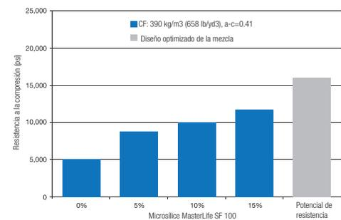
**Resistencia a la compresión:** Siendo una pozolana, la microsíllice MasterLife SF 100 reacciona químicamente dentro de la matriz cementicia para incrementar la cantidad del silicato de calcio hidratado (gel CSH) que se forma. El gel de CSH es el agente adherente que mantiene unida la matriz de una mezcla cementicia en su estado endurecido. El gel adicional de CSH incrementa la resistencia y disminuye la permeabilidad.
